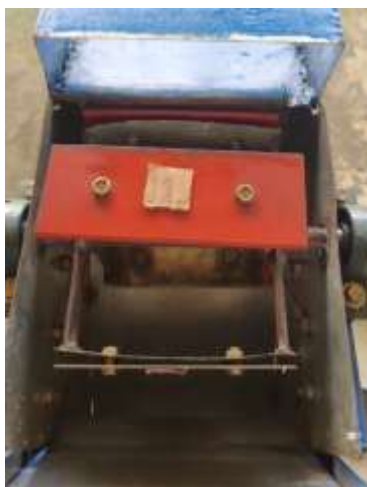
Gambar 4. 5 Kondisi Pada Saat Mata Pisau 3 diposisi Bawah
