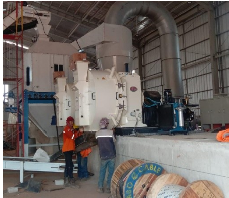
Gambar 3. 2 Mesin Pelletizer untuk pembentukan pelet kayu
