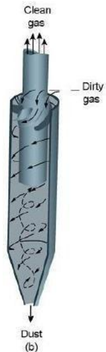
Gambar 2. 12 Cyclone Separator menggunakan Inlet Axial Sumber: (Fuad, 2020)
