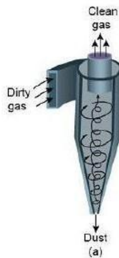
Gambar 2. 11 Cyclone Separator dengan masukan Inlet tangensial Sumber: (Fuad, 2020)
