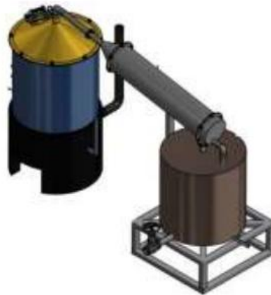
Gambar 2. 3 Pirolisis dengan reaktor vertikal dan burner kompor LPG Sumber: (Supriyanto dkk, 2017)
