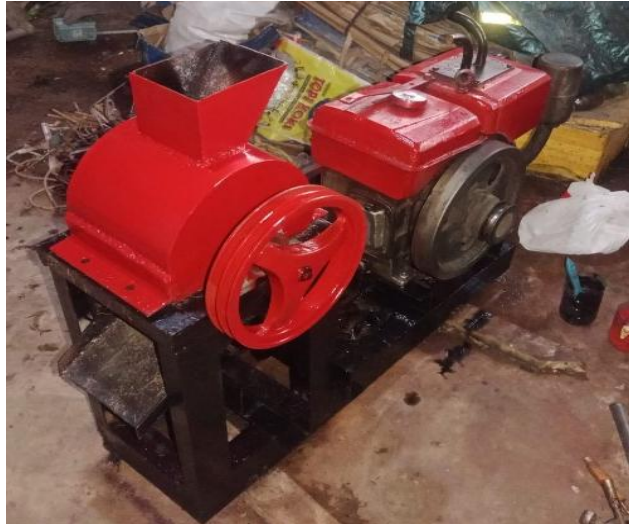
Gambar 4. 1 Hasil Pengerjaan Mesin Pencacah Limbah Kelapa Muda
