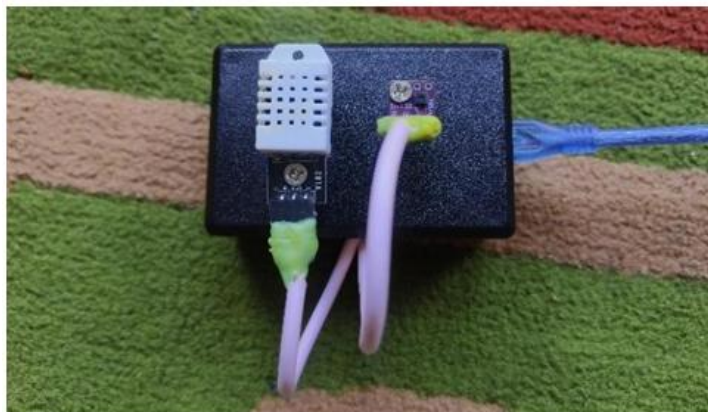
Gambar 2. 5 Alat Uji Sistem Kontrol Lingkungan
