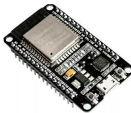
Gambar 2. 1 ESP 32 (Sumber: Hercog et al., 2023, hal. 6-20)
