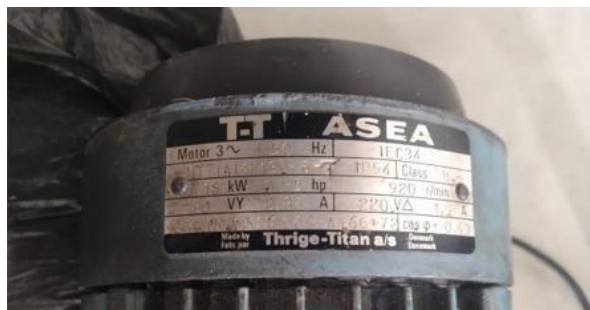
Gambar 2.2 Spesifikasi Motor Pertama
