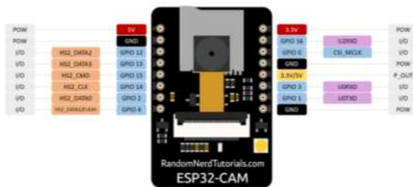
Gambar 2. 1 ESP32-CAM dengan Pin Out 1
