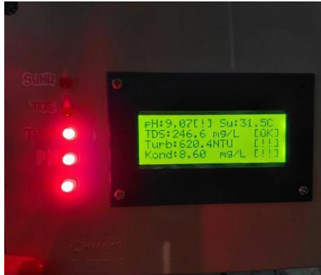
Gambar 4. 11 LED ON Dalam Kondisi Kualitas Air di Luar Range
