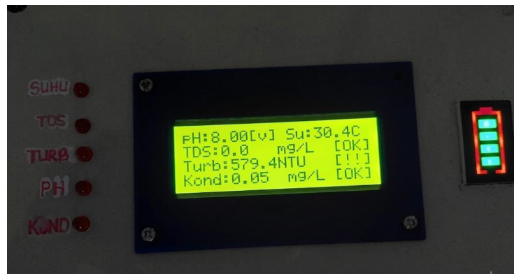
Gambar 4. 10 LED OFF Dalam Kondisi Kualitas Air dalam Range
