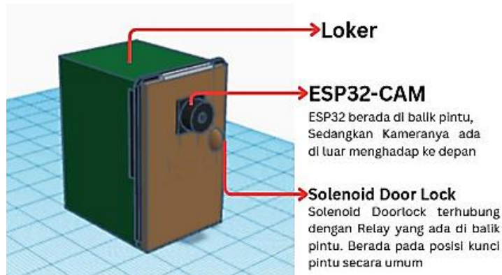
Gambar 2. 12 Smart locker dengan otentikasi menggunakan ESP CAM Ahmad dkk 1
