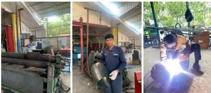
Gambar 4. 15 Proses Pengerjaan Tabung Kondenser luar.
