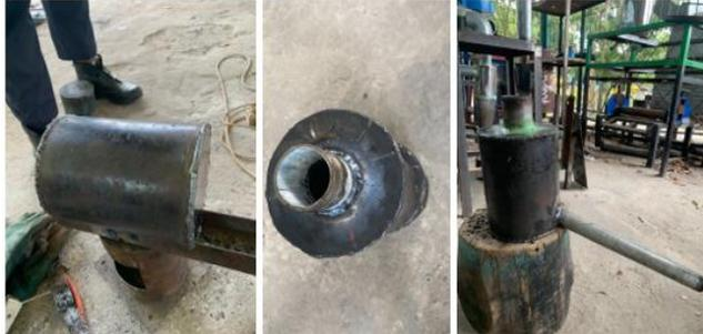
Gambar 4. 16 Proses Pengerjaan Tabung Kondenser dalam.
