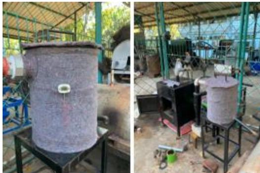
Gambar 4. 16 Pemasangan *Glaswool* pada Kondensor.
