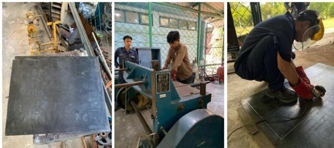
Gambar 4. 5 Proses pemotongan material Cover Rangka tungku.
