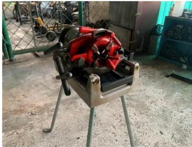
Gambar 2. 12 Mesin pengulir pipa otomatis
