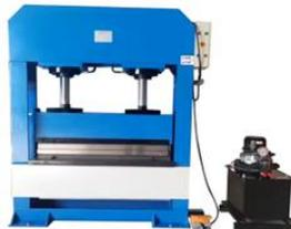
Gambar 2. 14 Mesin Bending Plat Hidrolik
