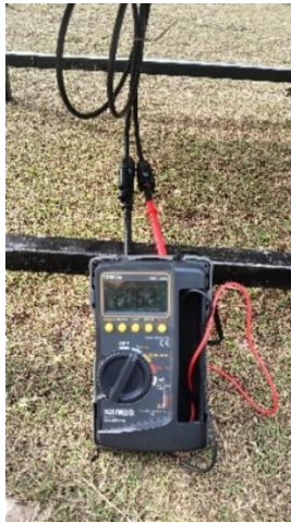
Gambar 4. 4 Proses pengukuran tegangan panel surya
