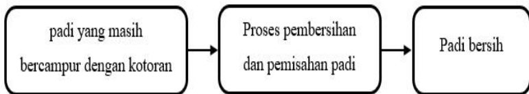
Gambar 3. 1 Diagram proses mesin pembersih gabah padi
