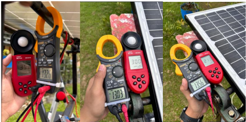
Gambar 4. 8 Pengukuran Nilai Tegangan Berdasarkan Intensitas Cahaya Matahari Tertinggi
