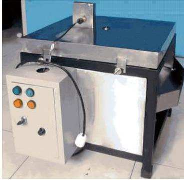
Gambar 2. 9 Mesin Pengiris Pisang Otomatis. (Palermo ., 2021).
