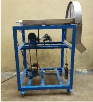
Gambar 2. 8 Mesin Pengiris keripik Berbasis Bandul.
