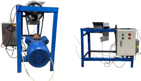
Gambar 4. 2 Tampak Depan dan Samping Mesin Pemotong Keripik Talas
