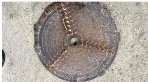
Gambar 4. 3 Hasil Perancangan dan Rancang bangun Mata Pamarut 5 arah
