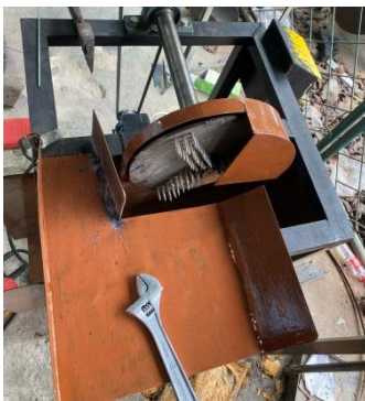
Gambar 4. 6 Pemasangan mata pamarut 3 arah
