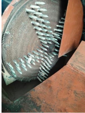
Gambar 4. 11 Pemasangan mata pamarut 5 arah
