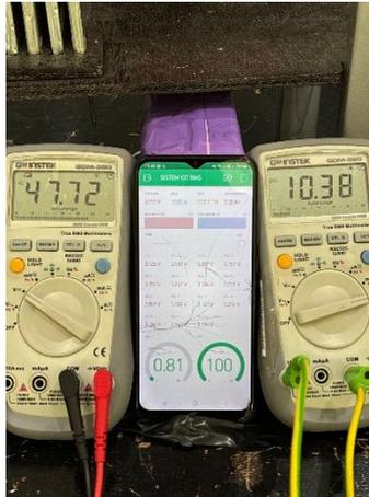
Gambar 4. 5 Pengujian Daya
