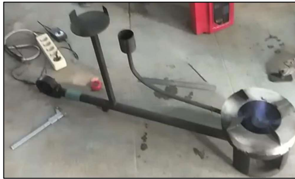
Gambar 2.13 Kompor Blower Berbahan Bakar Minyak Jelantah Sumber: Penelitian Farid dkk, (2023)
