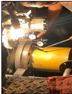
Gambar 4. 5 Pemasangan Dial Indicator (Sumber: Pribadi)
