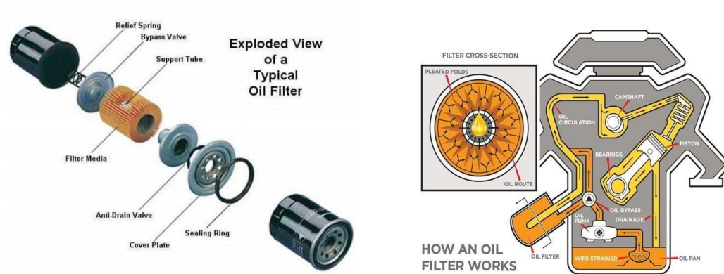
Gambar 2. 2 Mekanisme penyaringan dan parameter kinerja filter oli, diadopsi dari (Tien & Ramarao, 2007) dan (Mott et al., 2015).
