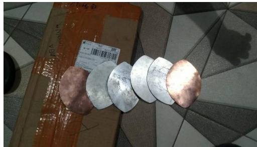
Gambar 2.14 Elektroda (Plat Tembaga dan Aluminium) Sumber : Dokumentasi Pribadi (2026)
