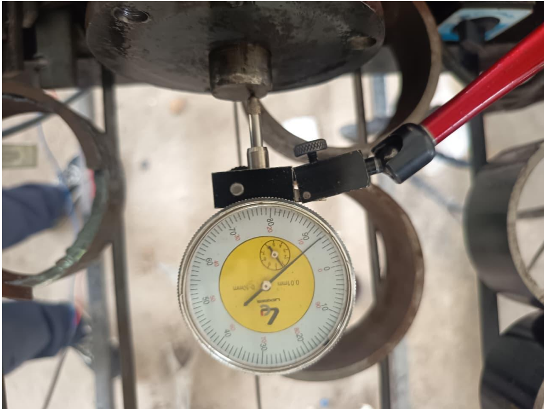
Gambar 4. 11 Pengujian Runout Axial Titik B
