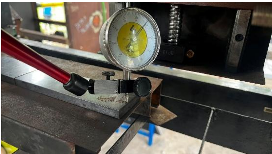
Gambar 4. 2 Titik Akhir Dial Indicator Pada Uji Kesejajaran
