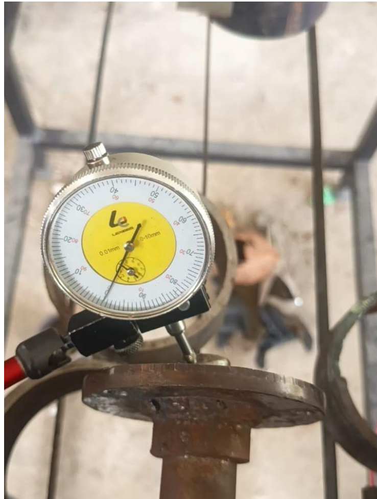
Gambar 4. 9 Pengujian Runout Radial Titik C
