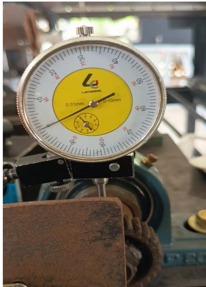
Gambar 4. 7 Pengujian Runout Radial Titik A
