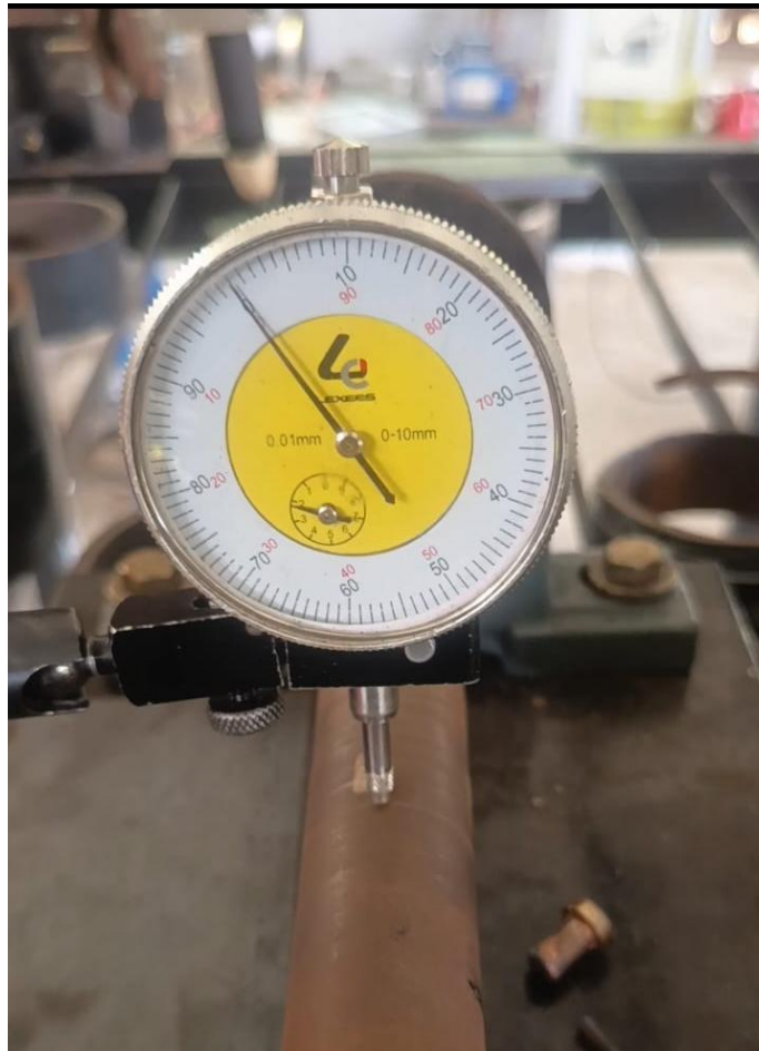
Gambar 4. 8 Pengujian Runout Radial Titik B
