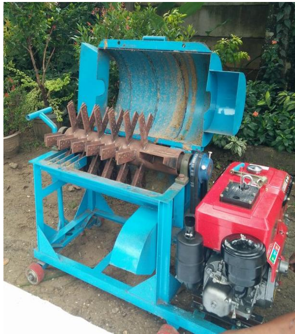
Gambar 2. 3 Mesin pencacah tongkol jagung dengan menggunakan mata pisau
