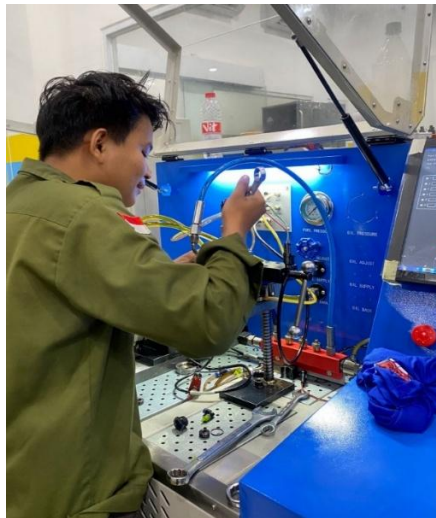
Gambar 4. 9 Setting Kalibrasi Injector Bosch/Denso
