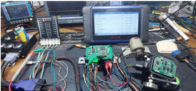
Foto Sistem Kalibrasi Software Autel pada modul EPS
