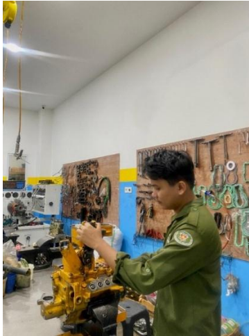
Gambar 4. 6 Perakitan Pompa Injeksi CAT308
