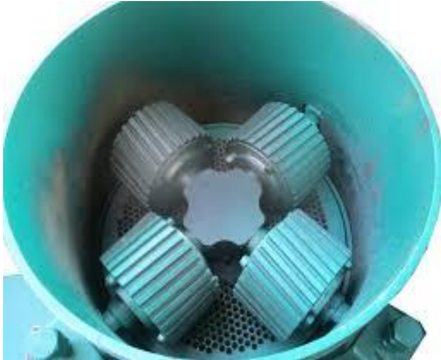
Gambar 2. 5 Mesin press tongkol jagung
