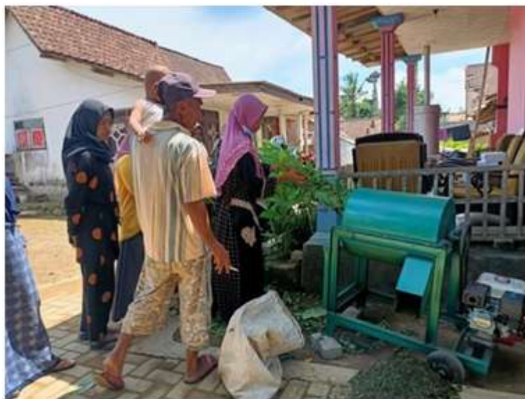
Gambar 2. 2 Praktek penggunaan mesin pencacah sampah, Trash Can-Composter oleh mitra (Ratna Dewi Syarifah dkk.,2022)
