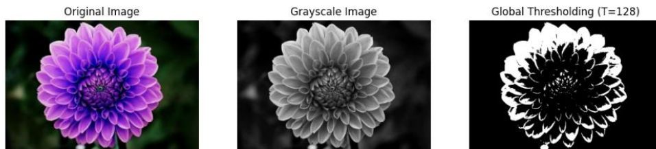
Gambar 2. 1 Proses segmentasi menggunakan thresholding (diadaptasi dari (Syaharuddin et al., 2025)). 1
