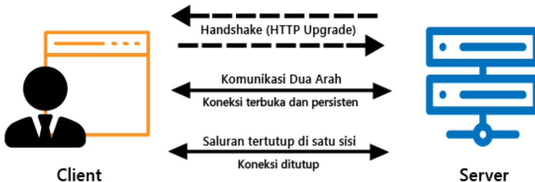
Gambar 2.4 Cara Kerja WebSocket 4
