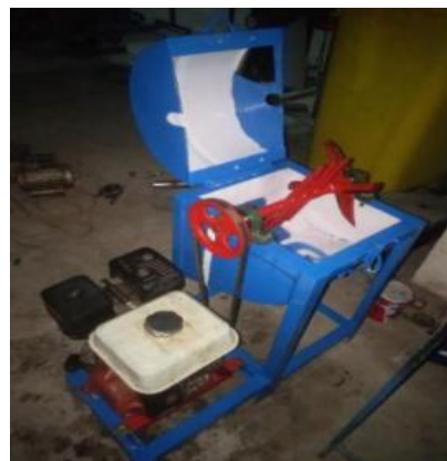
Gambar 2 15 Mesin Pencacah Pelepah Sawit Menggunakan Motor bensin 5,5 HP
