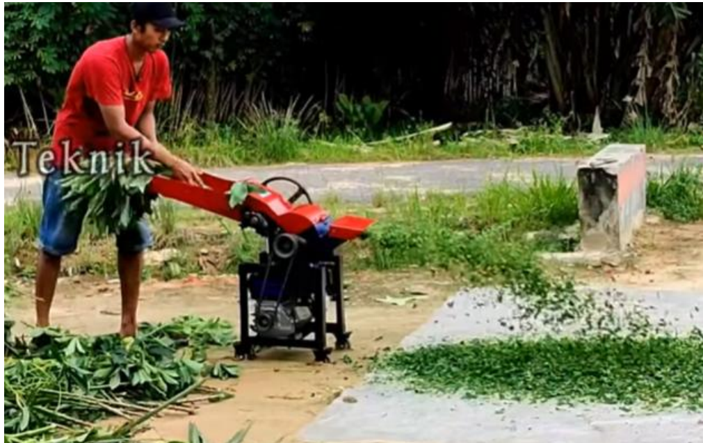
Gambar 2 12 Proses Keluarnya Hasil Cacahan pada Mesin Pencacah
