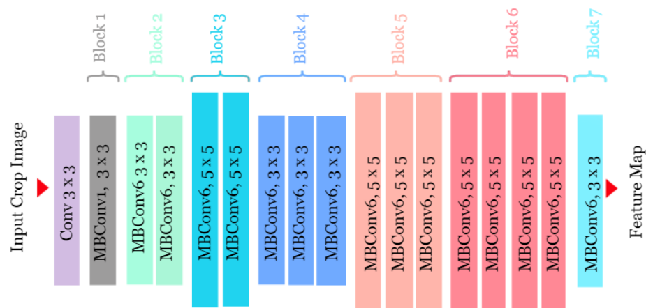
Gambar 2. 7 Arsitektur EfficientNetB0 (Sumber: Sapanca dkk. 2026)
