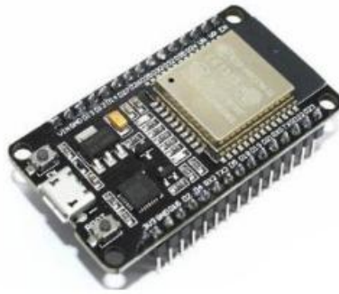
Gambar 2. 7 Modul Mikrokontroller ESP32 (Sumber : (Pratama & Kiswantono, 2023))
