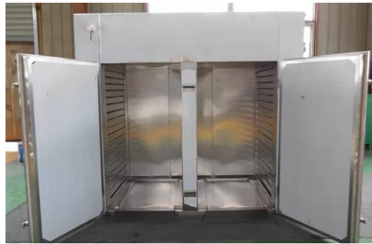
Gambar 2.3 Dryer system oven untuk makanan dan obat (Sumber.maksindo)
