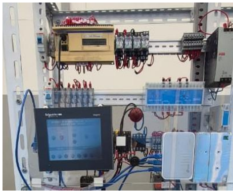
Gambar 4. 8 Realisasi koneksi HMI - switch Hub - PLC
