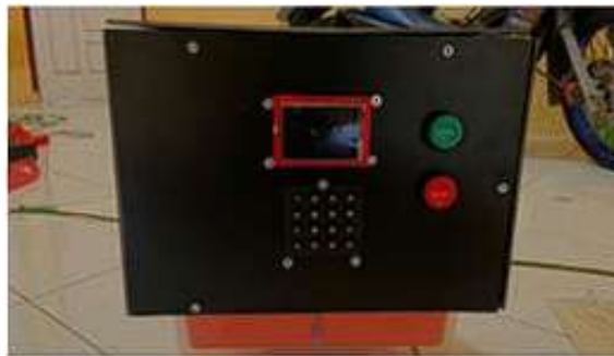
Gambar 2. 3 Alat Proteksi dan Monitoring Overcurrent dan Over/Undervoltage terhadap Motor 3 Fasa. 3
