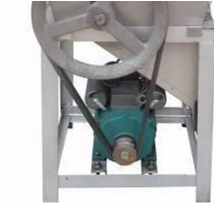
Gambar 2.15 Mesin Pencacah Tulang Ikan Tipe *Hammermill*
