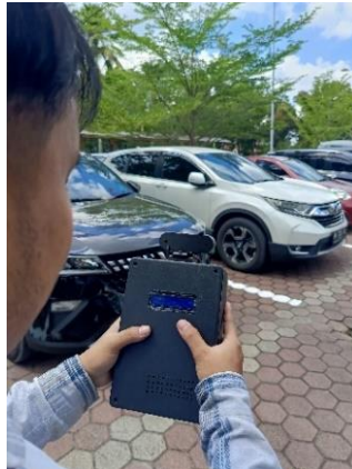
Gambar 4. 5 Deteksi Objek Mobil
