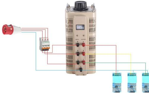
Gambar 4. 5 Rangkaian Pengujian Pengukuran Tegangan
