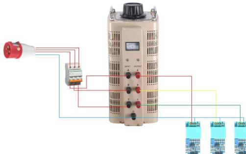
Gambar 4. 7 Rangkaian Pengujian *Under Voltage*
