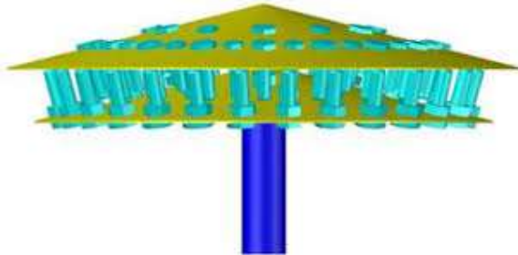
Gambar 2. 5 Pisau pengupas tipe ruji vertikal
