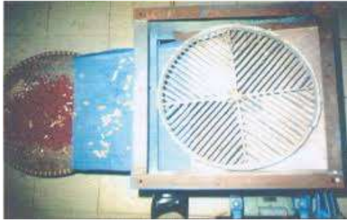
Gambar 2. 7 Pengembang alat pengupas kulit polong kacang tanah tipe piring
