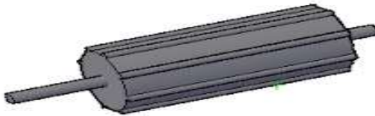
Gambar 2. 4 Pisau pengupas horizontal (Sumber :www.agroteknika.id)
