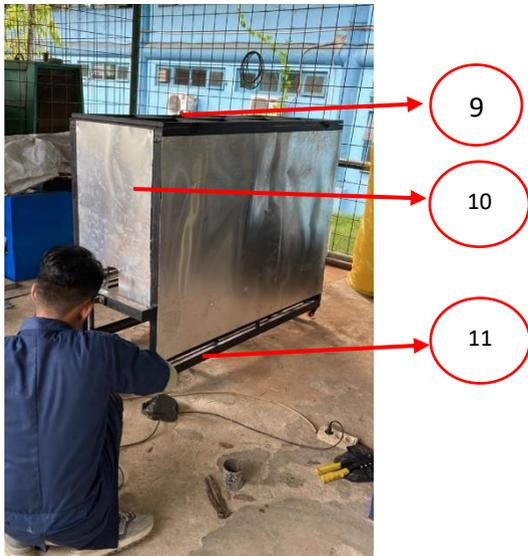
Gambar 4. 3 Rangka mesin Pembakar Lemang
