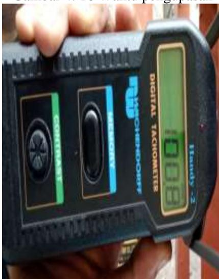
Gambar 4. 17 Kecepatan poros ( Rpm )
