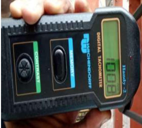
Gambar 4. 11 Kecepatan poros ( Rpm )
