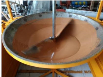
Gambar 2. 5 Proses pengadukan dodol secara permesinan
