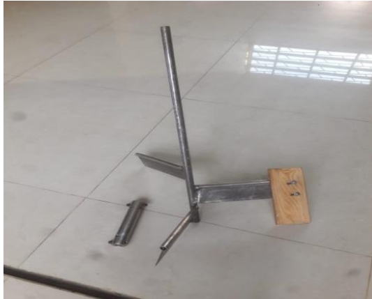
Gambar 4. 2 pengaduk dodol dengan 3 buah blade
